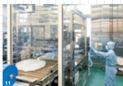
1.2.入浴剤「ババヤ桃源」と企画コンセプトの元となったババヤ。3.4.5.富山の自然の恵みを活かした商品開発をゼロから手掛けた「富山クオリティ」シリーズ。6.7.立山連峰を一望できる千里工場では、厳重な管理のもとで製造や研究開発を行う。8.V字型ミキサーを使い、入浴剤素材をムラなく混合させる浴用剤工場。9.分解された「濃塩水」は釜で炊くと、塩とにがりに分けられる。10.海洋深層水を3つに分解できる「多段式イオン交換電気透析装置」。11.130℃以上で殺菌された天然水をクリーンルーム内でバッグに充填する。
