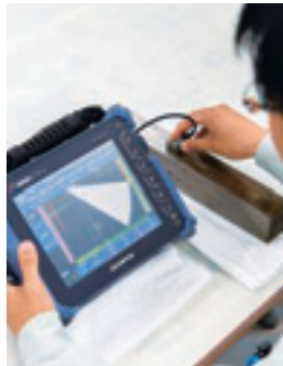
コンクリート内部の調査や、部品に傷や亀裂がないかを専用機器を使って念入りに調査する。
